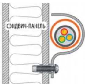
Рисунок 4 - Монтаж ОКЛ при помощи резьбовой заклепки и винта к поверхности из сэндвич-панелей
