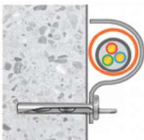
Рисунок 2 - Монтаж ОКЛ при помощи анкер-клина к поверхности из кирпича/бетона
