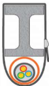
Рисунок 8 - Монтаж ОКЛ в обхват горизонтальных металлических конструкций
