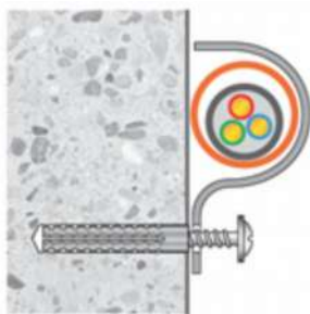
Рисунок 1 - Монтаж ОКЛ при помощи дюбеля и самореза к поверхности из кирпича/бетона
