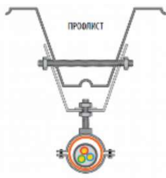
Рисунок 8 - Монтаж ОКЛ в обхват горизонтальных металлических конструкций
