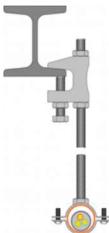
Рисунок 10 - Монтаж ОКЛ к металлическим несущим конструкциям, металлической балке, балке двутавровой, металлическому профилю, уголку
