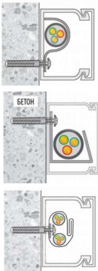
Рисунок 11 - Монтаж ОКЛ в кабельном канале при помощи дюбеля и самореза к поверхности из кирпича/бетона
